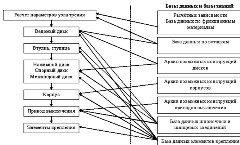
Рис. 5. Последовательность проектирования тормоза
